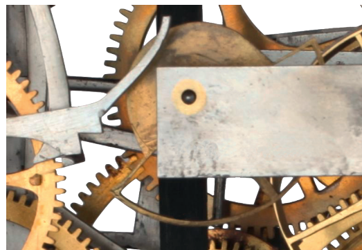
Abb. 5 GS2W1 mit automatischer Nachtabschaltung des Schlagwerks
